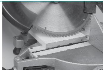
Após o corte, guarde o pedaço pequeno que sobrou, que deve ter um lado cortado em 45º e outro lado em 90º, pois esta peça será usada para o acabamento de topo do rodapé.
