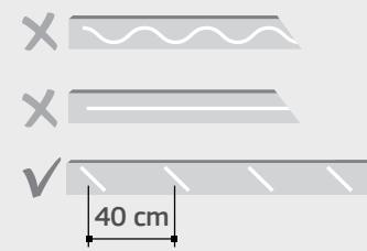
Fixe o rodapé na parede exercendo pressão, de forma que o adesivo tenha contato com ambas as superfícies. Se precisar, dê leves batidas com o martelo de borracha para ajustar.
