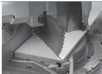
Após o corte, guarde o pedaço pequeno que sobrou, que deve ter um lado cortado em 45º e outro lado em 90º, pois esta peça será usada para o acabamento de topo do rodapé.
